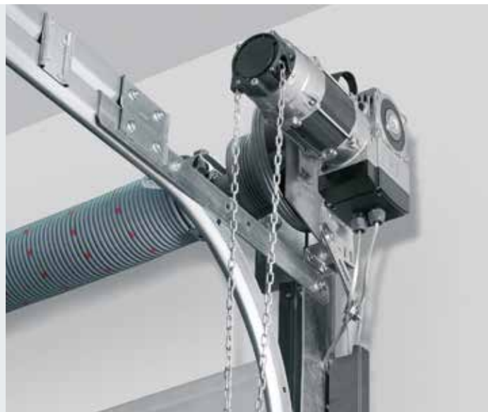
Стандартное положение для монтажа — горизонтальное, в качестве альтернативы — вертикальное; на рис. изображено устройство с цепной ручной аварийной деблокировкой (опция)
